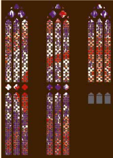
Die fünf Fenster der gotischen Kathedrale von Roermond (NL) produzieren dank Südlage einige tausend Kilowattstunden Strom im Jahr.
